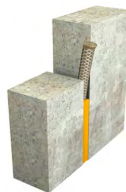
Cordão de fundo de junta resistente ao fogo e selante convencional
